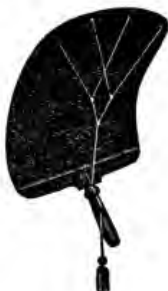
Fig. 2. Das Audiphone in Spannung; die richtige Position, um damit hören zu können.
